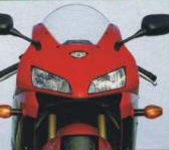
Honda CBR 600 RR Brave Frontansicht mit unauffälligen Ansaugöffnungen
