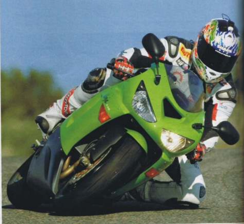
Honda CBR 600 RR Brave Frontansicht mit unauffälligen Ansaugöffnungen
